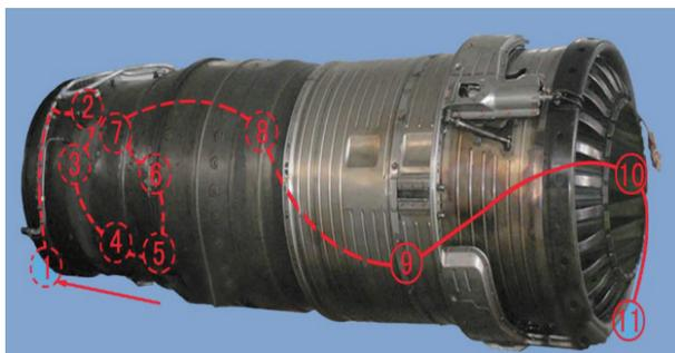
图 6-2 机械日涡轮和加力燃烧室的检查路线
