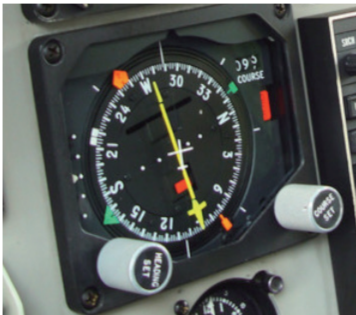
图 7-2-1 直升机组罗盘指示器实物图
