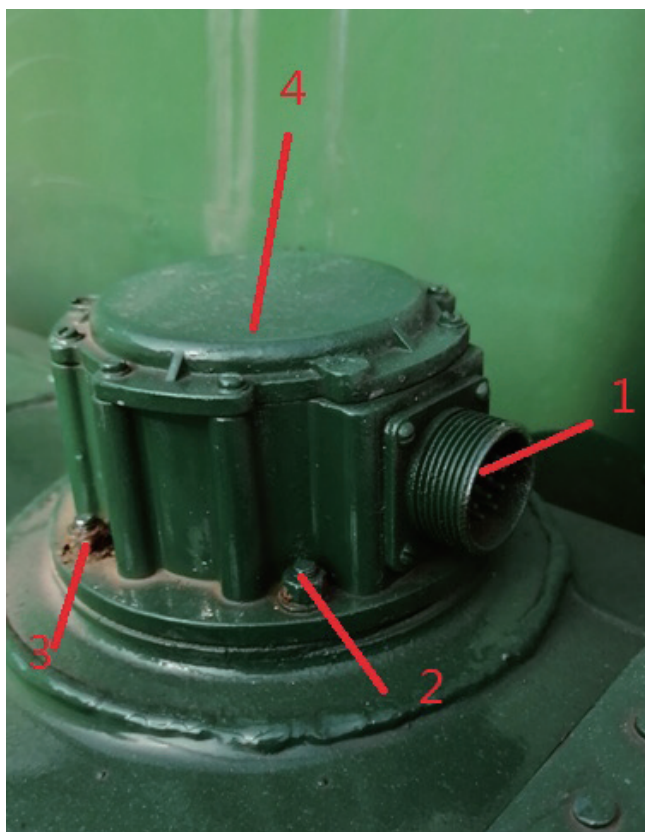
图 7-1-1 飞机油量表传感器实物及位置图
