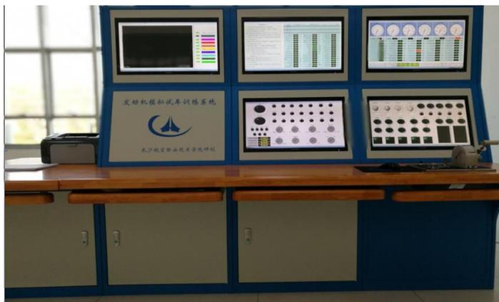
图 1 发动机试车操纵台
