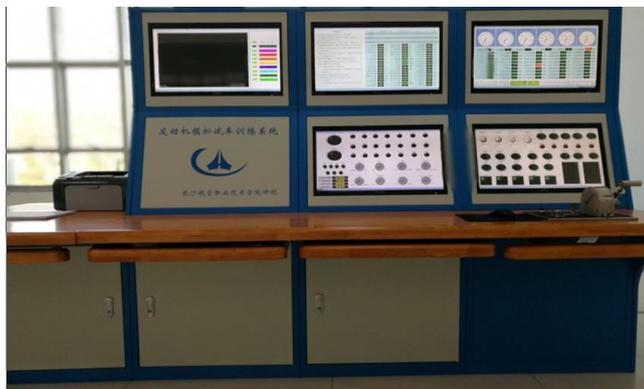
图 1 发动机试车操纵台
