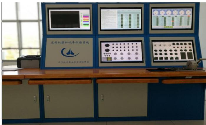
图 1 发动机试车操纵台
