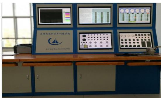
图 1 发动机试车操纵台
