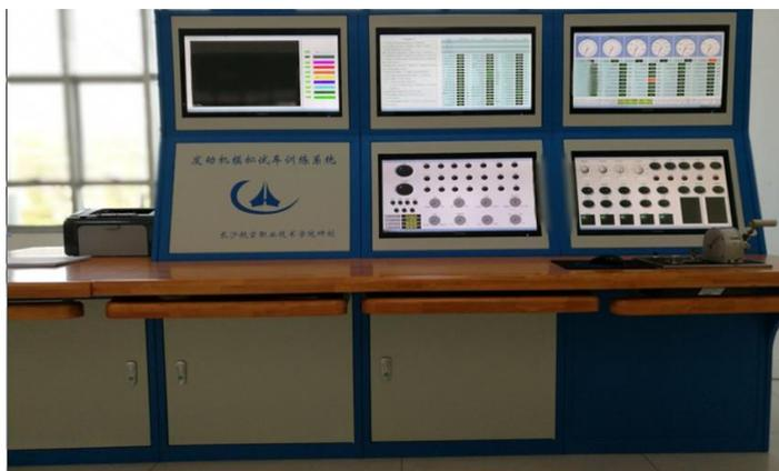
图 1 发动机试车操纵台
