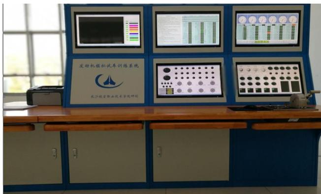
图 1 发动机试车操纵台
